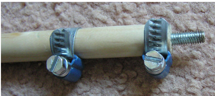
Vastgelijmd in de 14mm roede, voorzien van twee slangenklemmen
